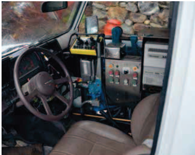
Der «Elektro-Beudon»: Links ein Blick ins Cockpit, rechts der elektrifizierte Suzuki-Geländewagen in Aktion. Am linken Bildrand ist der Zeilenwagen zu sehen, der mit dem Hebekran von einer Rebzeile in die nächste gehoben wird. Die Energie kommt aus dem betriebseigenen Wasserkraftwerk.
