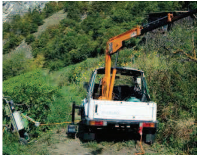
Der «Elektro-Beudon»: Links ein Blick ins Cockpit, rechts der elektrifizierte Suzuki-Geländewagen in Aktion. Am linken Bildrand ist der Zeilenwagen zu sehen, der mit dem Hebekran von einer Rebzeile in die nächste gehoben wird. Die Energie kommt aus dem betriebseigenen Wasserkraftwerk.
